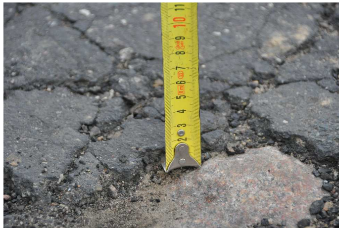
Fot. 5: Istniejąca grubość warstwy ścieralnej na środku jezdni na odcinku nr 2.
