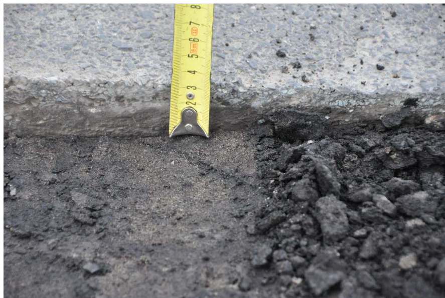
Fot. 8: Wycinek nawierzchni jezdni na odcinku nr 3 (strona lewa)
