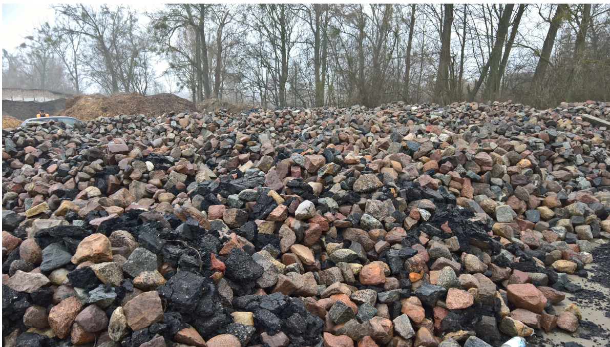
Fot.1: Kostka kamienna nieregularna 15/17 cm do przebrania (materiał Inwestora).
